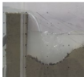
写真-1 洗掘孔の様子
