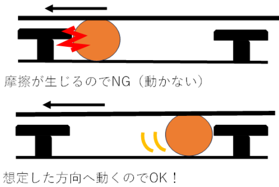
図-1 せん断土槽のベアリングの動き
