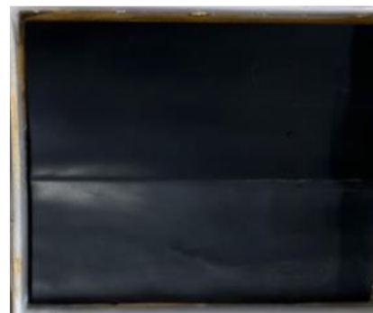
図-4 ゴムシートによる不透水境界の模擬
