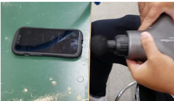
図-3 マッサージガンによる振動の付与
