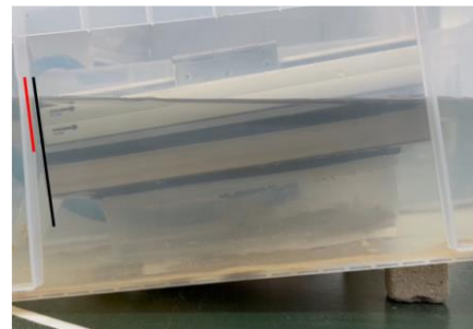
図-6 振動入力後の土槽の変位
