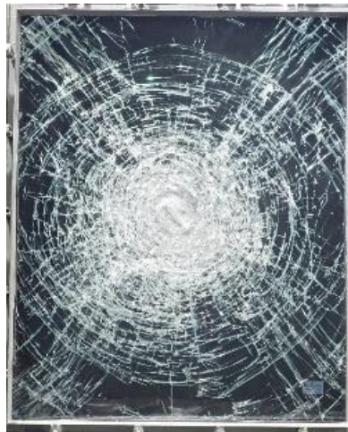
写真 1 繰り返し圧力载荷試験後の破損状況
