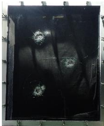
写真 1 加撃体衝突後の破損状況
