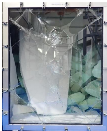
写真 1 繰返し圧力载荷試験後の破損状況
