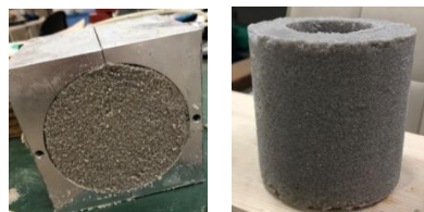
図 1 成型した中空円筒供試体
