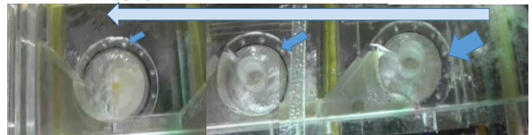
図 5 3 連立坑構造における洪水流下特性
