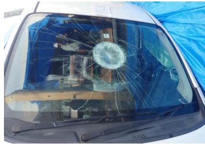
氷の衝突により割れた自動車のフロントガラス
