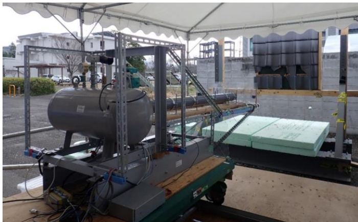
衝撃試験装置を用いて瓦屋根の模型に加撃体を衝突させている様子
