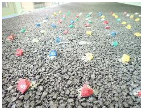
写真2 砂利模型（色付き） 風洞内での砂利模型を用いた飛散実験の様子
