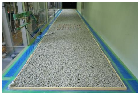
写真1 風洞内に敷き詰められた砂利
